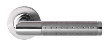
Béquille en inox qualité AISI 304 de forme à angle droit 90°, de diamètre 20 mm et de longueur 141 mm, pied et embout en inox poli brillant, sur la partie la plus longue du balustre en inox brossé est perforé sur sa circonférence tous les 10 mm, de saillie 64 mm se terminant droite.
