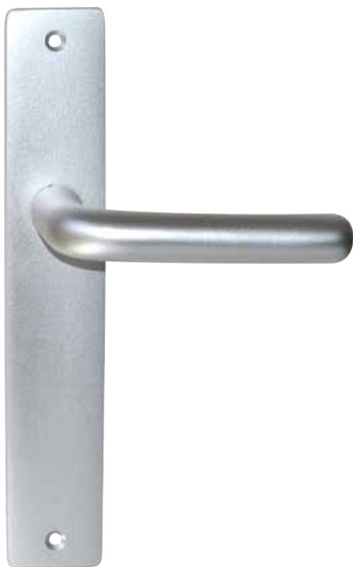
Béquille avec un retour coudé en L se terminant en forme demi-sphérique en aluminium et finition naturel perlé, de diamètre 19 mm, de longueur 110 mm et de saillie 60 mm.
