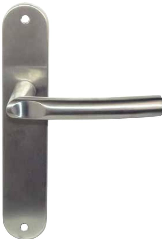
Béquille en inox brossé qualité AISI 304 à angle droit 90° avec partie incurvée pour y positionner le pouce sur la partie cintrée la plus longue se terminant par un embout droit, de 19 mm de diamètre, de longueur 130 mm et saillie de 68 mm.
