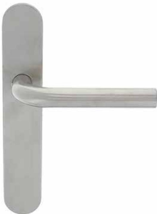
Béquille de 19 mm de diamètre en inox brossé qualité AISI 304 avec retour coudé en L, longueur de 143 mm et saillie de 68 mm. Montée sur sa contre-plaque de fixation, fournie avec cache inox, de hauteur 226 mm et de largeur 41 mm, entraxe de fixations de 195 mm, se terminant en arrondi de chaque côté.
