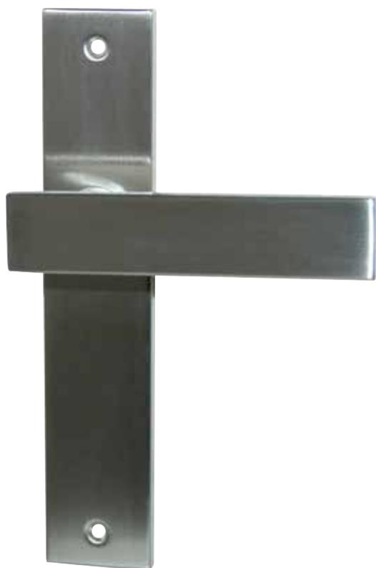
Béquille de forme rectangulaire en inox brossé qualité AISI 304, de 135 mm de longueur et 40 mm de hauteur, avec une épaisseur de 10 mm qui dépasse de 10 mm par rapport à l'axe de rotation de la béquille, sur sa partie la plus courte. Elle se termine par des embouts droits.
