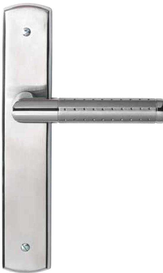
Béquille en inox qualité AISI 304 de forme à angle droit, de diamètre 20 mm, de longueur 138 mm, pied et embout en inox poli brillant, sur la partie la plus longue du balustre en inox brossé qui est perforé sur sa circonférence tous les 10 mm, de saillie 64 mm, se terminant droite.
