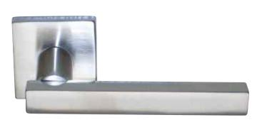
Béquille carrée de 16,8 mm de côté en ligne droite, finition en laiton nickel mat, de longueur 125 mm et saillie de 64 mm, avec une partie qui dépasse de 15 mm vers la gauche par rapport à son axe de rotation de diamètre 22 mm.
